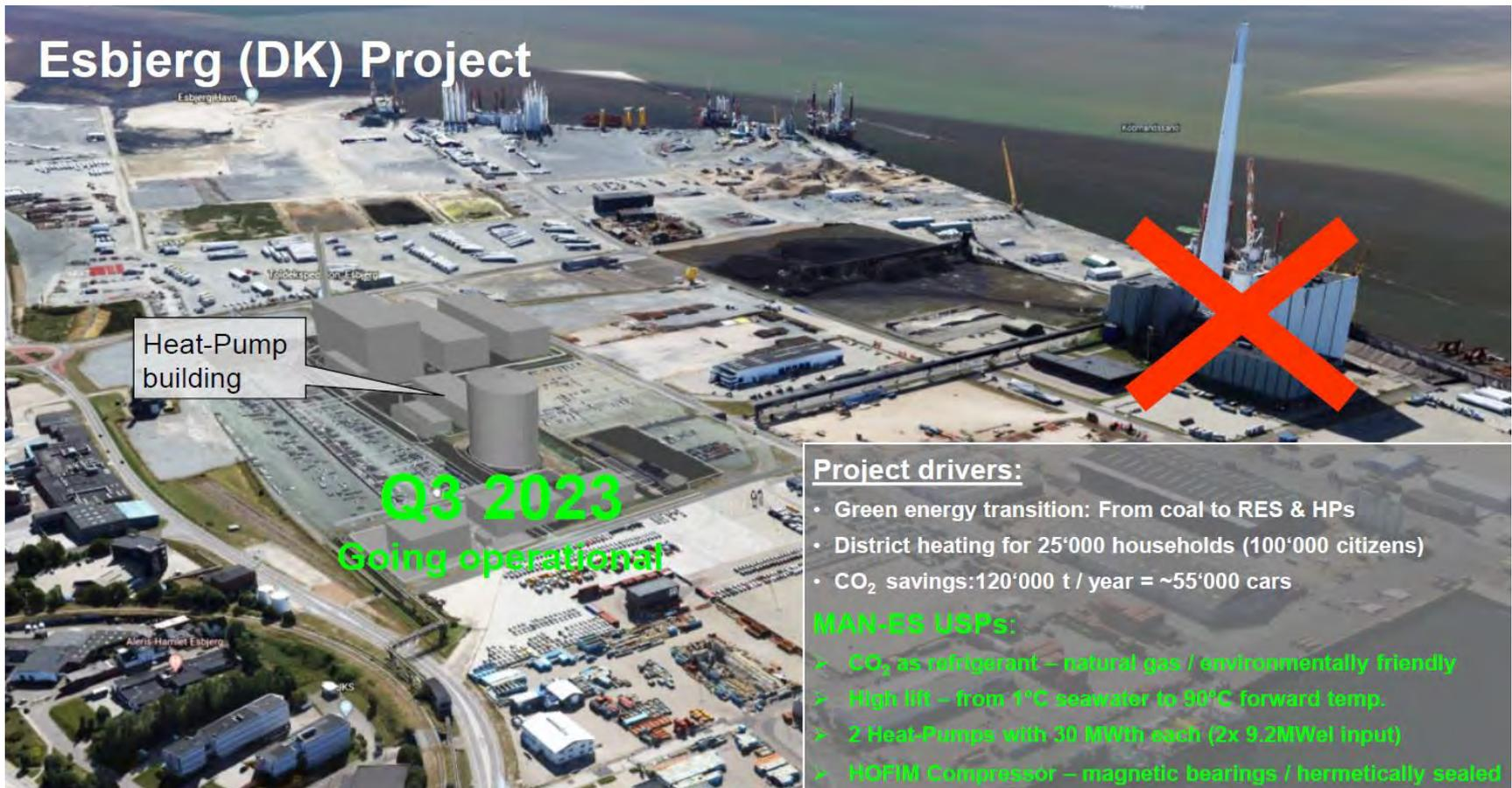
In Esbjerg wurden zwei Wärmepumpen mit jeweils 30 MW<sub>th</sub> installiert. Nach erfolgter Inbetriebnahme wird dadurch das Kohleheizkraftwerk ersetzt. Primäre Wärmequelle für die Wärmepumpe ist Meerwasser.
